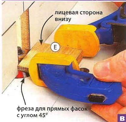
В целях безопасности надежно зажимают заготовку для подпятника Е струбциной. Переворачивают ее лицевой стороной вниз и снимают с кромки фаску под углом 45° шириной 6 мм. Переставляя струбцину, поочередно снимают фаски на остальных кромках.
