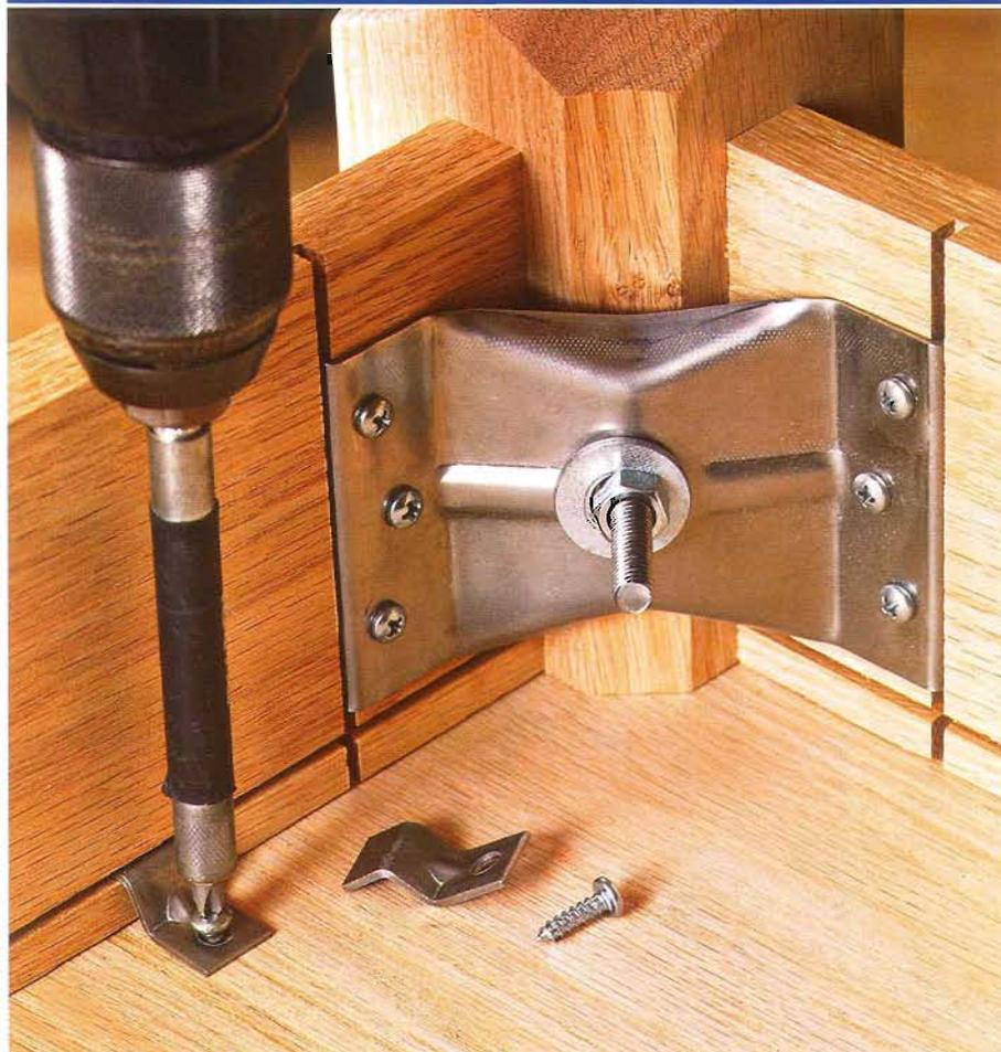
Один конец Z-скобы с помощью шурупа прочно крепится к крышке стола, а другой – входит в узкий паз, пропиленный в царге (см. фото).
