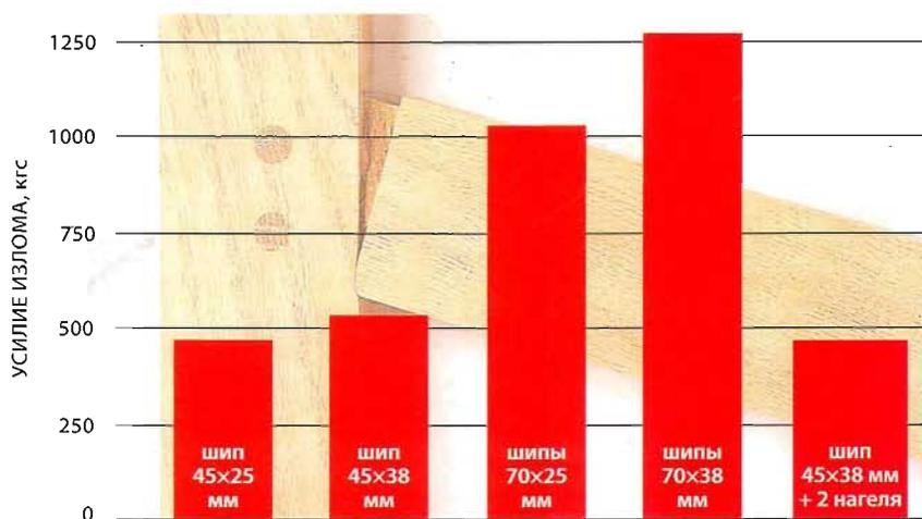
Для верстаков, столов или стеллажей, испытывающих значительные боковые нагрузки в повседневной эксплуатации или при перемещении, шиповые соединения незаменимы. Увеличение ширины шипа на 57% более чем вдвое увеличивает прочность соединения.
