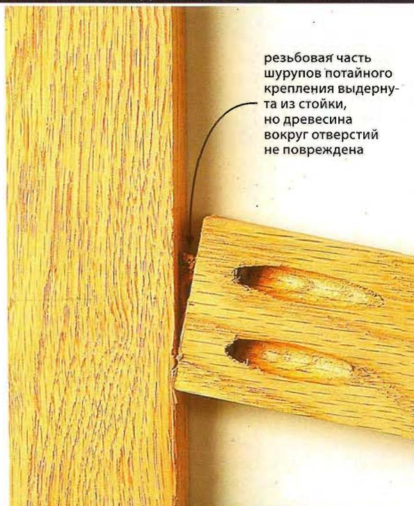
резбовая часть шурупов потайного крепления выдернута из стойки, но древесина вокруг отверстий не повреждена
