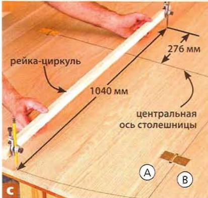
Разметьте центры закруглений концов крышки А от центральной оси и прочертите линии с помощью циркуля из рейки.
