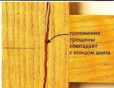
положение трещины совпадает с концом шипа
