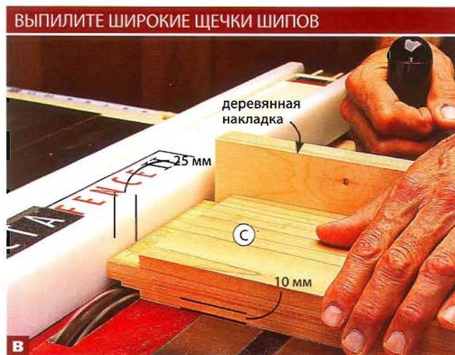
**В** Выпилите на концах заготовок шипы длиной 25 мм, ограничивая их длину продольным упором пилы. Чтобы не было сколов на выходе, установите на подвижный упор-каретку дополнительную деревянную накладку.
