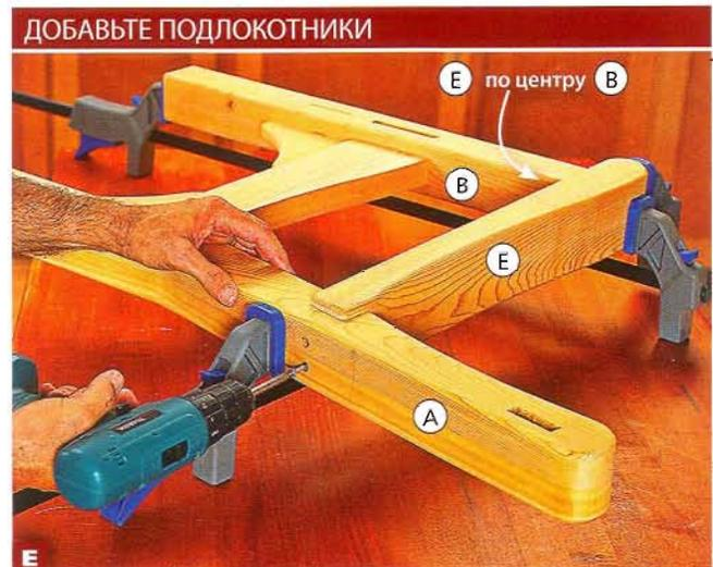
Приклейте на место подлокотники и прижмите их струбцинами. Через отверстия в задних ножках просверлите заходные отверстия для шурупов в подлокотниках и вверните шурупы.
