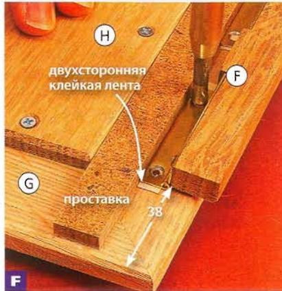
Петельную планку F располагают строго по центру заднего края крышки Г, прижимая петли к проставке. Сверлят в крышке направляющие отверстия для шурупов.
