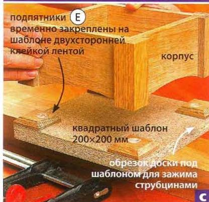
Подпятники Е крепят к квадратному шаблону для выравнивания. Их внешние углы и стороны совмещают с углами и сторонами шаблона. Затем на них наносят клей и опускают собранный корпус коробки. Коробку выравнивают относительно подпятников и прижимают к шаблону струбцинами.
