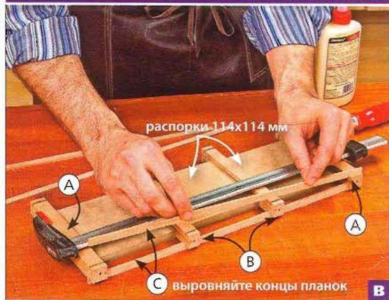
Вставьте распорки между стойками А и В, выровняйте концы стоек и скрепите их струбцинами. Вклейте планки С в пазы стоек.
