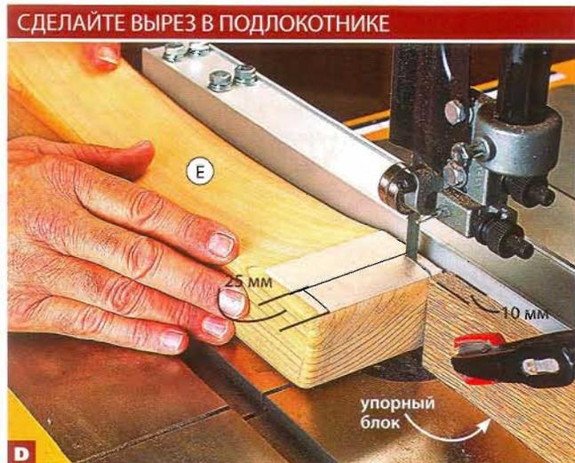
Установив продольный упор ленточной пилы в 10 мм от пильного полотна, а упорный блок в 25 мм от переднего края полотна, пропилийте один край выреза.
