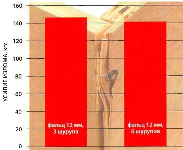
Удвоение числа шурупов ослабляет древесину, и соединения становятся менее прочными.
