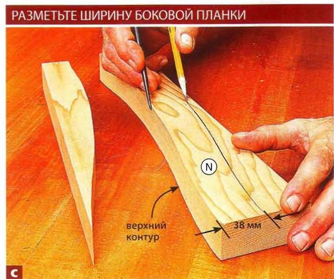
**С** Разведя ножки циркуля на 38 мм, скопируйте линию верхнего контура детали N на боковую сторону.
