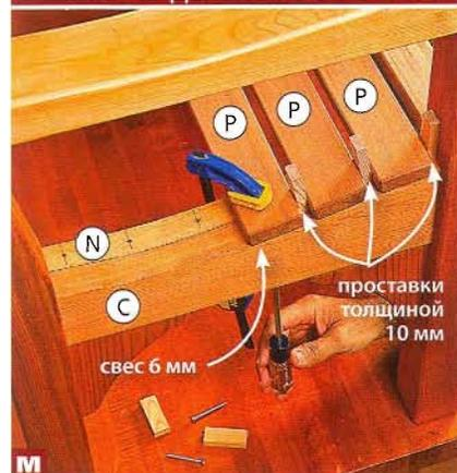
Используя проставки толщиной 10 мм, расположите планки сиденья Р с равными интервалами, прижмите их струбцинами, просверлите отверстия и вверните шурупы в опорные планки М, N.
