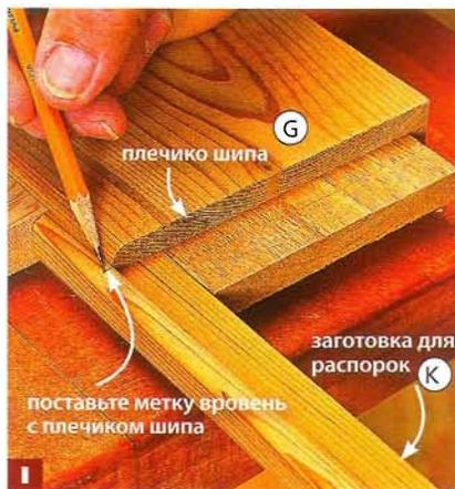
Вставьте в паз перекладки остаток заготовки для распорок и отметьте длину концевой распорки вровень с плечиком шипа.
