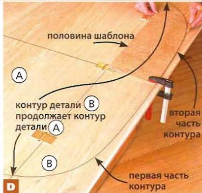
Совместите шаблон с линией закругления на крышке А и прочертите по нему половину контура бокового крыла В. Переверните шаблон и разметьте вторую половину детали.
