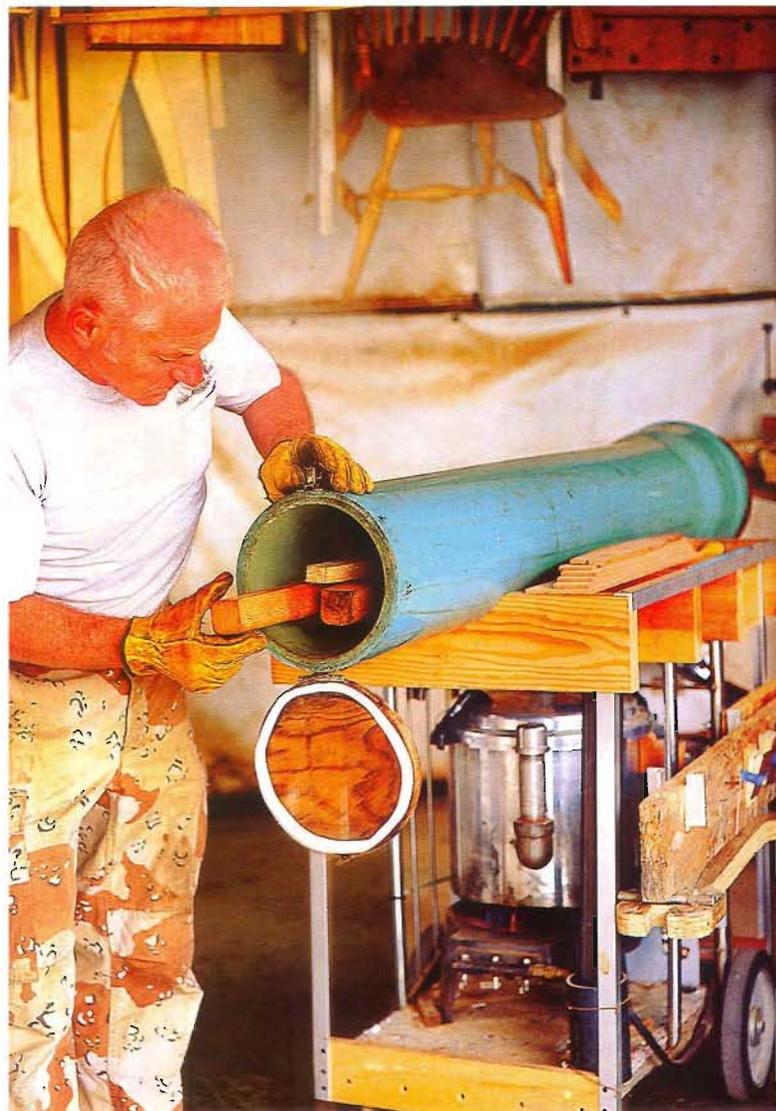
Паровая камера, бак для воды, горелка и опора для форм установлены на тележке, так их удобнее хранить, чтобы в любой момент быть готовым к гнутью.
