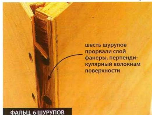
Увеличение числа шурупов снижает прочность на излом соединения в фальц 12 мм фанеры толщиной 18 мм, что видно на этом образце. В испытаниях на разрыв фальцы, усиленные шестью шурупами, оказались ненамного прочнее образцов с тремя шурупами.
